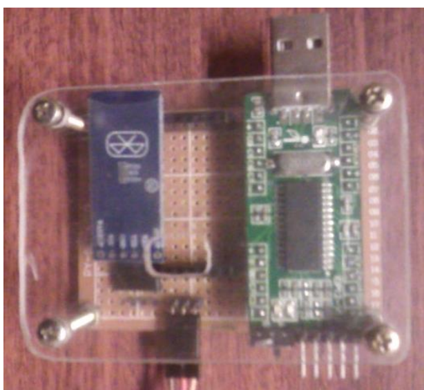
Figura 9. Módulo Bluetooth HC-06 y Circuito electrónico de control.
