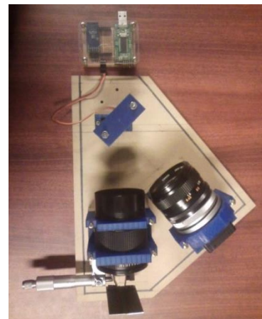
Figura 17. Vista superior interna del sistema óptico y sistema de control movimiento de la rejilla
